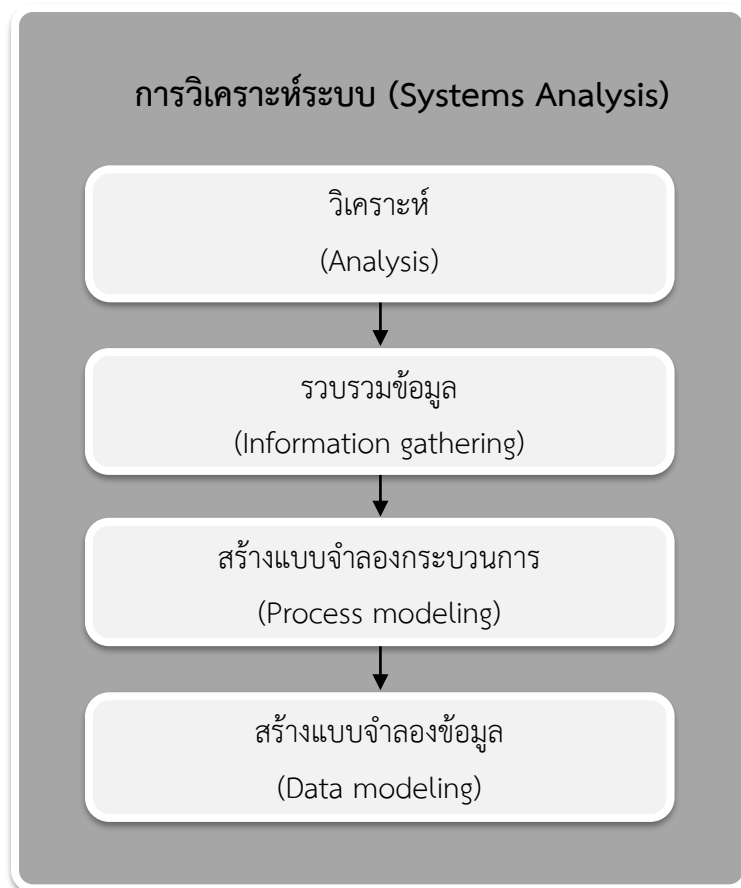
รูปที่ 5 แสดงขั้นตอนการวิเคราะห์ระบบ (Systems Analysis)
